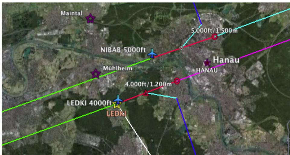
Um den Erfordernissen der ICAO gerecht zu werden, müssen die Verfahren so konstruiert werden, dass die Luftfahrzeuge ab den angegebenen Punkten (Orange) entlang des Endanfluges, oder von der Seite (Zyan) in den Höhen 1.500m (Nord) und 1.200m (Süd) in der festgelegten Höhe sein können.
