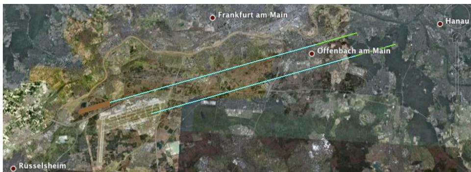
Ein Luftfahrzeug in 10NM Abstand von der Schwelle der Südbahn (25L) befindet sich auf dem Gleitweg in 3.500ft, während das nördliche Luftfahrzeug in 11,7NM von der Schwelle entfernt 4.000ft benötigt.
