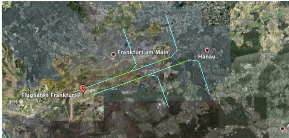
Die blauen Linien zeigen die Entfernung von jeweils 5NM (9,3km) bzw 10NM (18,5km) bis zur Landebahnschwelle, die grünen Linien zeigen den Bereich des 2NM (3,7km) Horizontalfluges, die weiteren blauen Linien zeigen die 30° Anschneidewinkel zum Endanflug und die Eindrehstrecken vom Gegenanflug .
