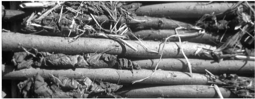
**Abb. 10:** Die Innenseite einer im Experiment mit Lehm beworfenen Flechtwand zeigt den durchgedrückten Lehm mit Grasabdrücken.
