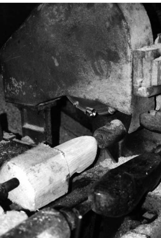
Ein Holzschuh wird in der Kopiermaschine analog einem Eisenschuh abgedreht.
