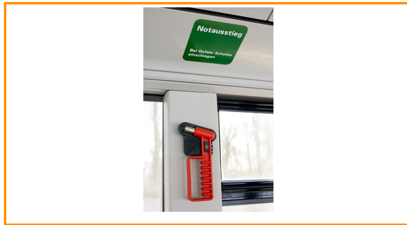
Abbildung 11: Notausstieg: Schild und Nothammer (Quelle: Continental AG)
